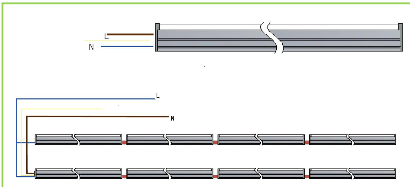
**LE NOMBRE DE TUBES LED REGLETTES T5—18W—120CM EST AU MAXIMUM DE 6 POUR UN RACCORDEMENT EN SERIE.**
