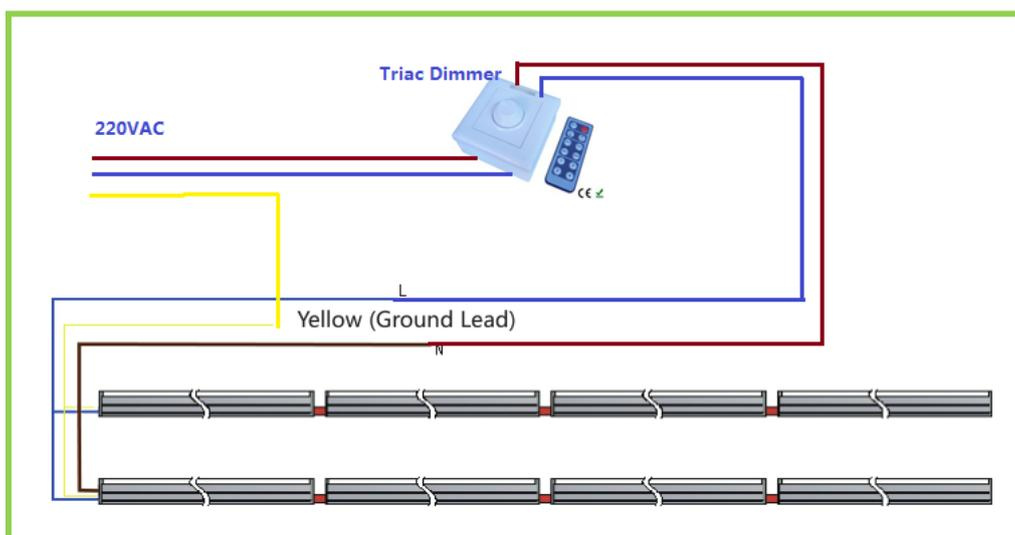
**LE NOMBRE DE TUBES LED REGLETTES T5—18W—120CM EST AU MAXIMUM DE 4 POUR UN RACCORDEMENT EN SERIE.**
